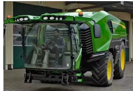
2022: 700 (250) PS mit 1000 kWh Batterie (Versuchsmaschine SESAM 2)
