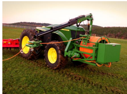
2017: John Deere mit Kabel, 204 PS am Rad, 272 PS für externe Antriebe
