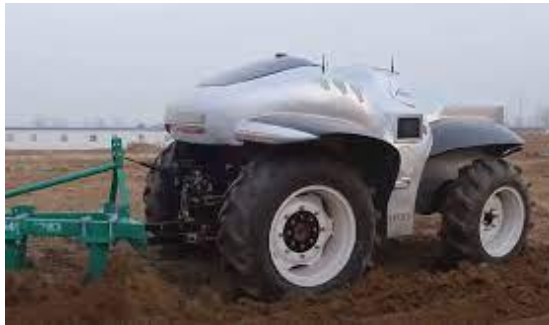
2020: autonom fahrender Brennstoffzellentraktor aus China, Tankvolumen: 4 Std
