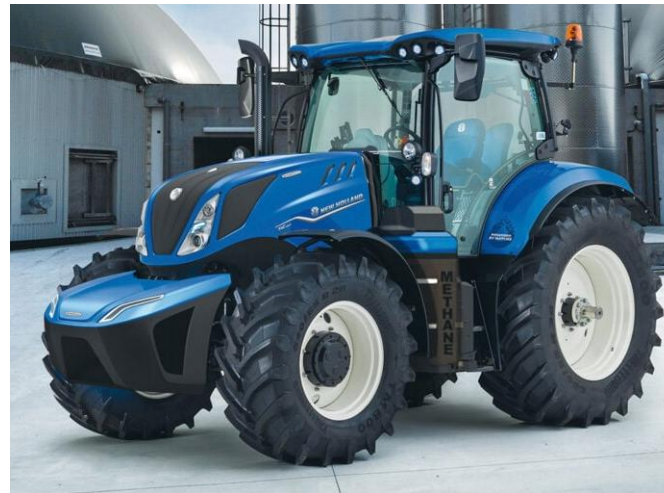
2021: Serie NH T6 180 Tankvolumen: 53 kg Methan, reicht für 3 Stunden
